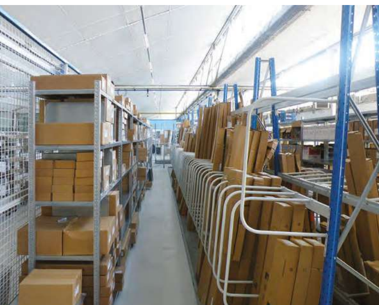
Marchandises sous carton stockées dans des rayonnages verticaux double face accessibles par deux allées de circulation (Gallorema)
