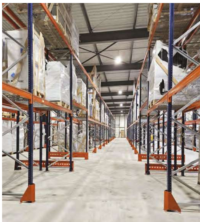
Zone d'entrepasage constituée de rayonnages ACTI-RACK grande hauteur, avec allées et couloirs sécurisés pour permettre le passage des personnes et des chariots élévateurs en évitant les risques de collision (Classotech)
