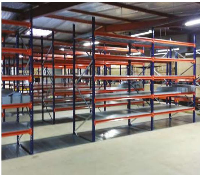
Rayonnages ACTI·RACK installés sur toute la hauteur du bâtiment, avec plancher en aggloméré standard et platelages métalliques pour sécuriser les allées de passage sur les niveaux de stockage (Classotech)
